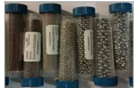
verschiedene Beads (Edelstahl rostfrei, Glas, Zirkoniumoxid, Zirkoniumsilikat)
